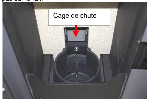
Fig. 35 : cage de chute des granulés
