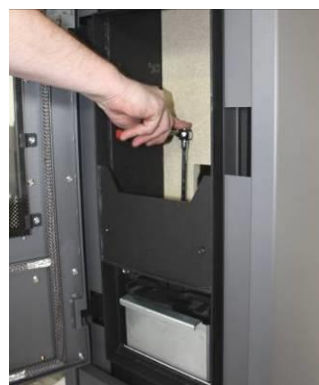
Fig. 21 : dévissage du pot brûleur
