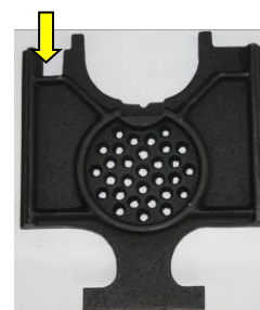
Fig. 14 : grille en fonte mal positionnée
