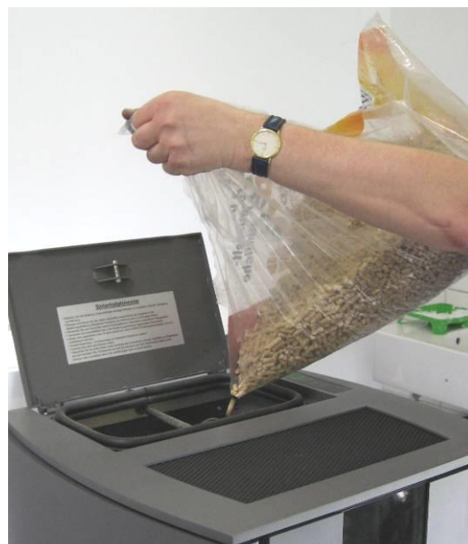
Fig. 4 : remplissage avec des granulés
